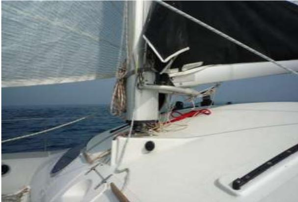
Gros plan sur la rotule du mât-pivotant, une solution qui optimise l'écoulement laminaire du vent sur la grand-voile.
