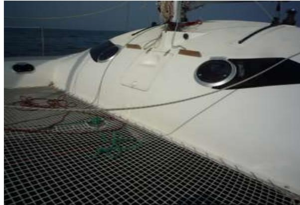
Quatre hublots ouvrants permettent d'aérer le roof central qui abrite le carré, le coin cuisine et une table transformable en couchette double.
