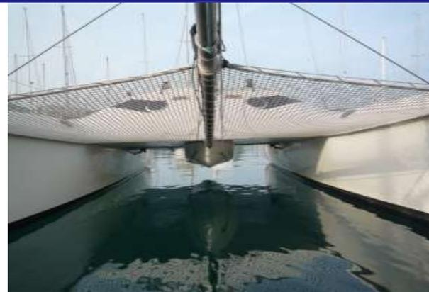
De belles solutions sont mises en œuvre avec des barres en carbone et paliers auto-alignants, un palan de grand-voile à 2 vitesses et 8 brins, dont 3 dans la bôme, une coque en sandwich PVC-verre-polyester en infusion.
