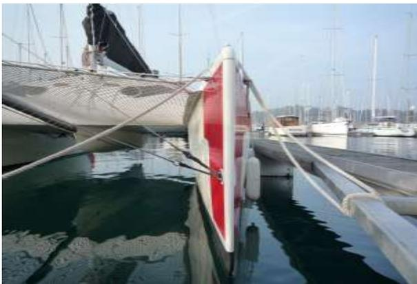
Des coques en V profond, une nacelle avec coqueron moteur d'une hauteur suffisante au-dessus de l'eau, des qualités qui laissent augurer un bon passage dans la mer formée.
